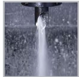
• Kühlung kann direkt durch den Bohrer auf die Wendeplattenspitze geführt werden
