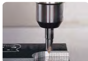
• Drehen, Fasen, Plandrehen auf einer CNC-Maschine.
