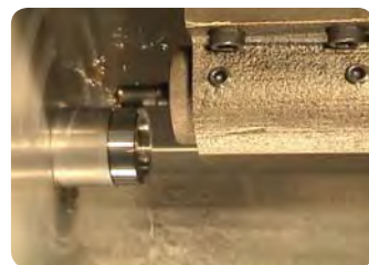
• Drehen, Fasen, Plandrehen auf einer CNC-Maschine.
