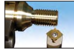
Gewindedrehen mit Steigung (0,5 - 3mm)
