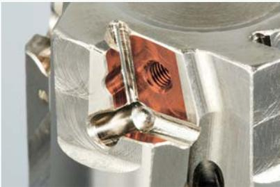
Der hohe Traganteil sorgt für eine besonders sichere Klemmung der WSP. Dies ermöglicht eine zuverlässige und stabile Bearbeitung unter schwersten Bedingungen.
