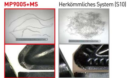
Ergebnisse MP9005 – stabile Zerspanung und weniger Verschleiß bei langer Werkzeugstandzeit und ohne Spanverhaken.
