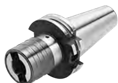
Gewindeschneid-Schnellwechselfutter mit Längenausgleich auf Druck und Zug
