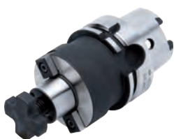
Quernut-Aufsteckfräserdorne DIN 6357 mit vergrößerter Anlagefläche und Kühlkanal- bohrungen an der Stirnseite
